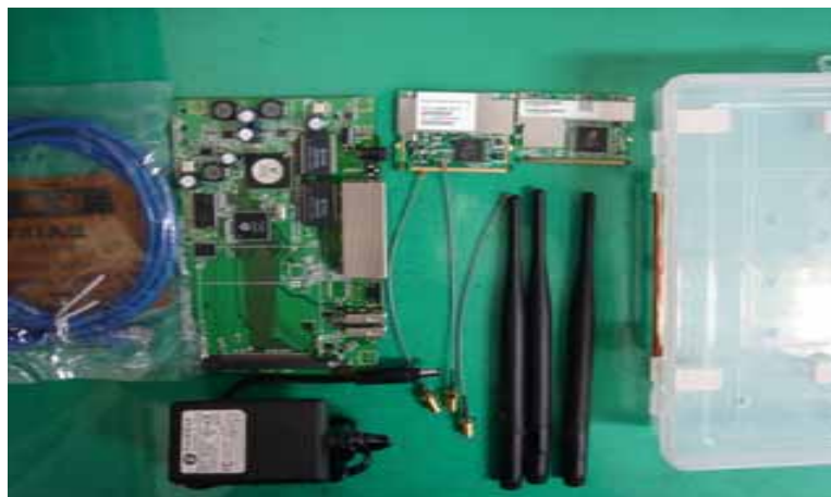
試作基盤ボードと主要パーツ(組立前)
